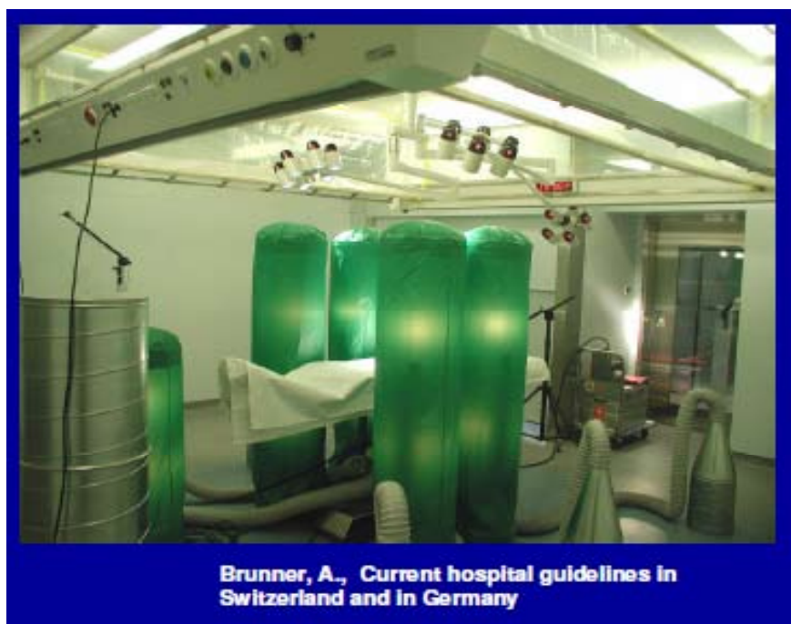
Rys. 7. Przykład testu oceniającego efekt ochrony w zakresie nawiewu laminarnego w sali operacyjnej klasy H1a 14 23
